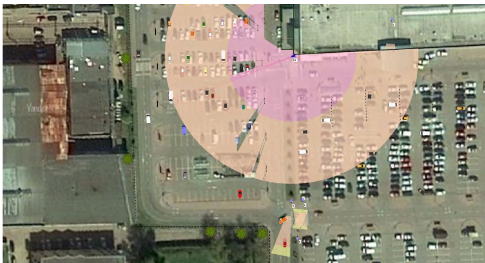
Вариант применения высокоскоростных поворотных камер - установка на угол здания
