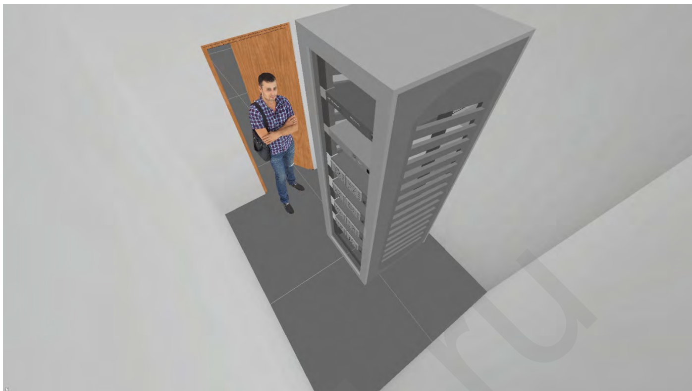
Центральное оборудование размещается в 19" серверной стойке
