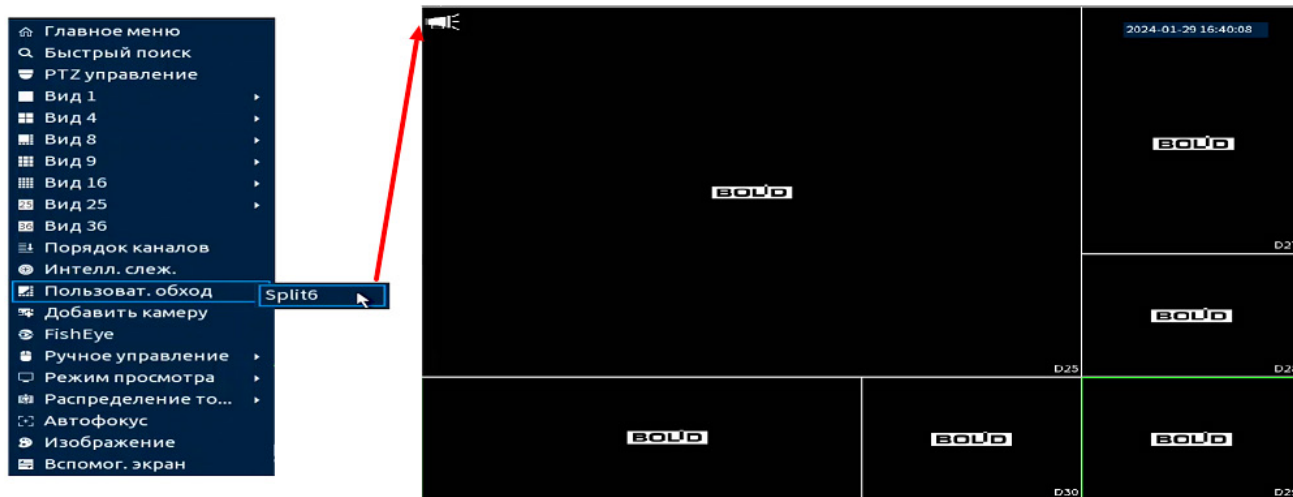
Рисунок 23.23 – Вывод сохранённой раскладки
