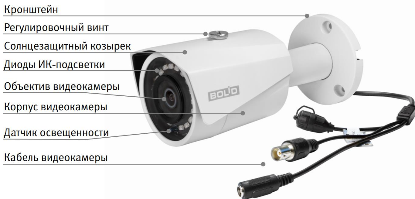
Рисунок 4.1 – Внешний вид и основные элементы видеокамеры
