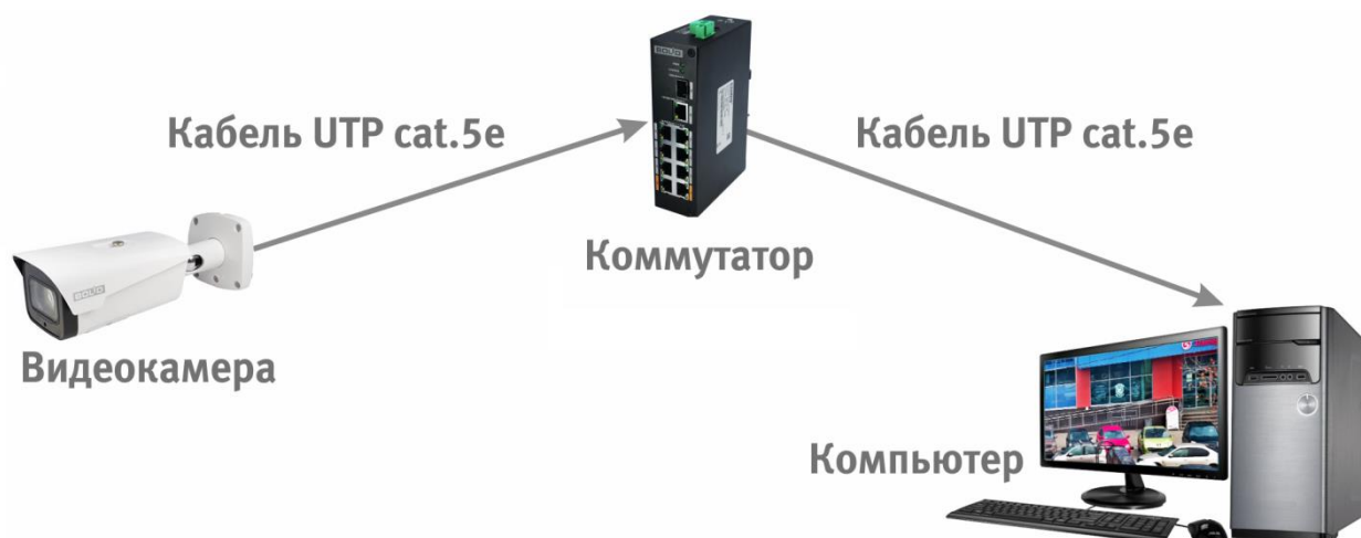
Рисунок 6.4 – Схема подключения видеокамеры к компьютеру через коммутатор
