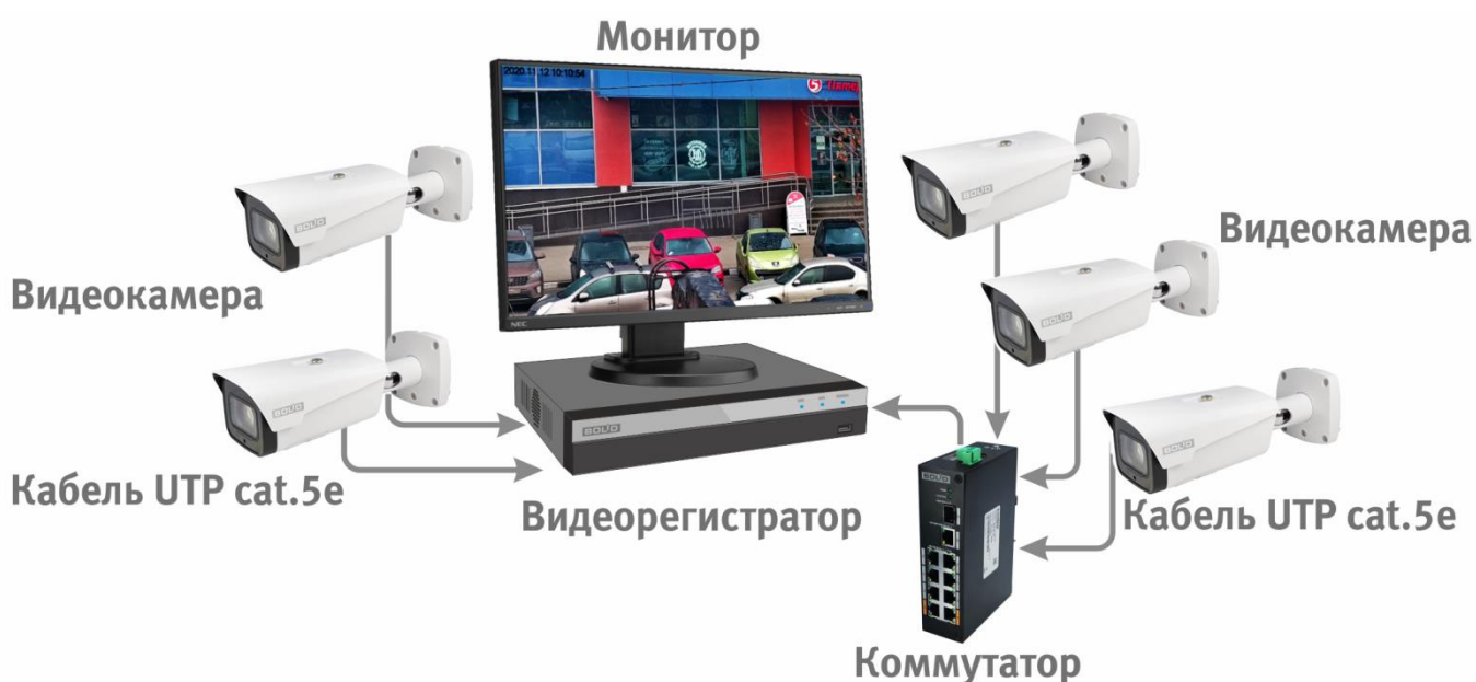
Рисунок 6.5 – Схема подключения видеокамеры к видеорегистратору
