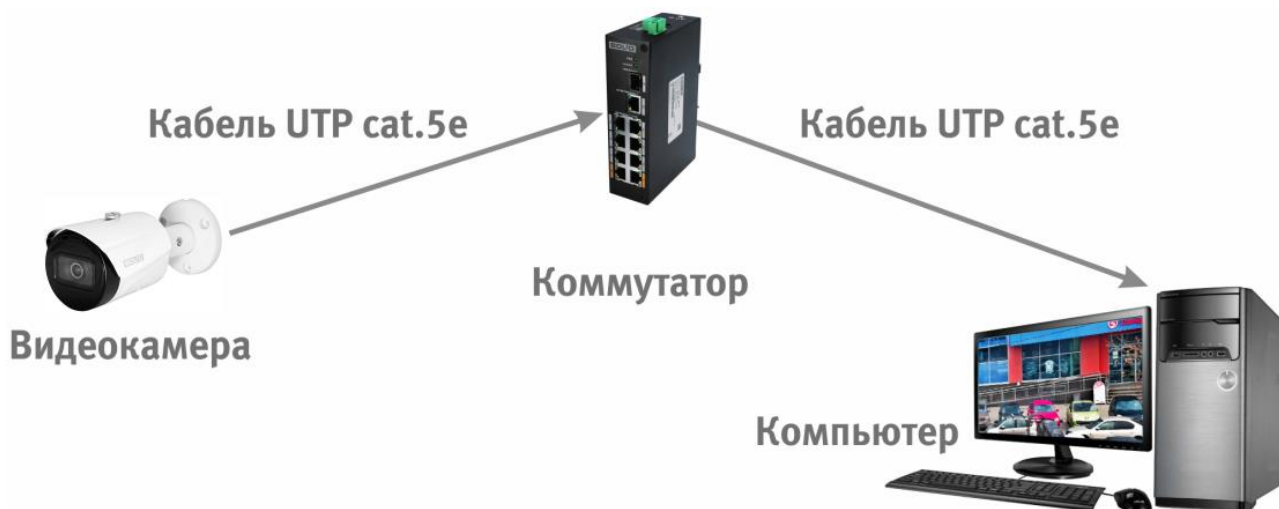
Рисунок 6.3 – Схема подключения видеокамеры к компьютеру через коммутатор
