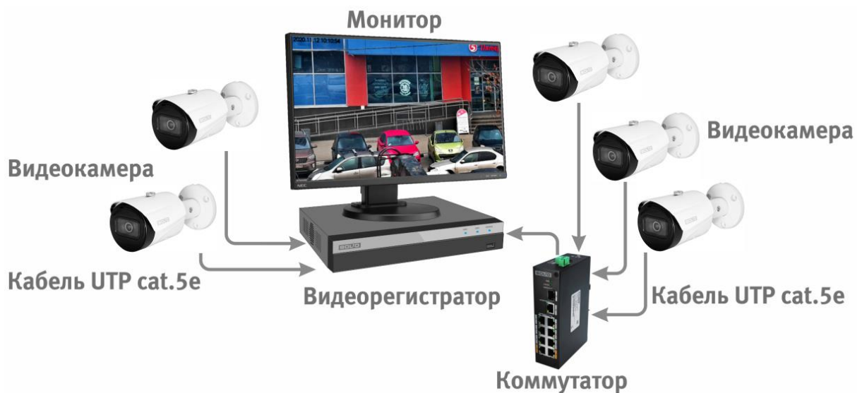
Рисунок 6.4 – Схема подключения видеокamеры к видеорегистратору
