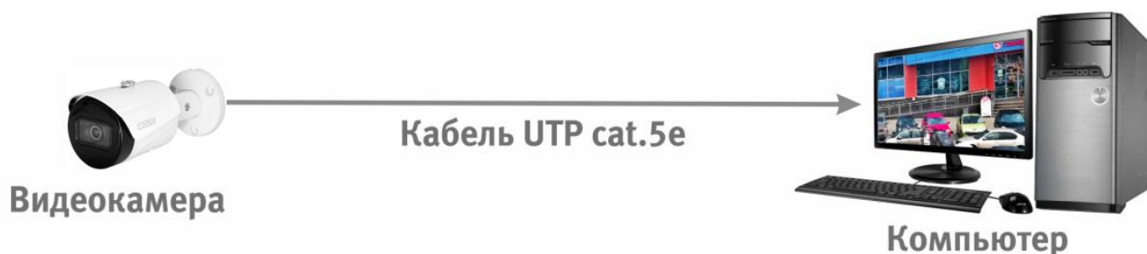
Рисунок 6.2 – Схема подключения видеокамеры к компьютеру
