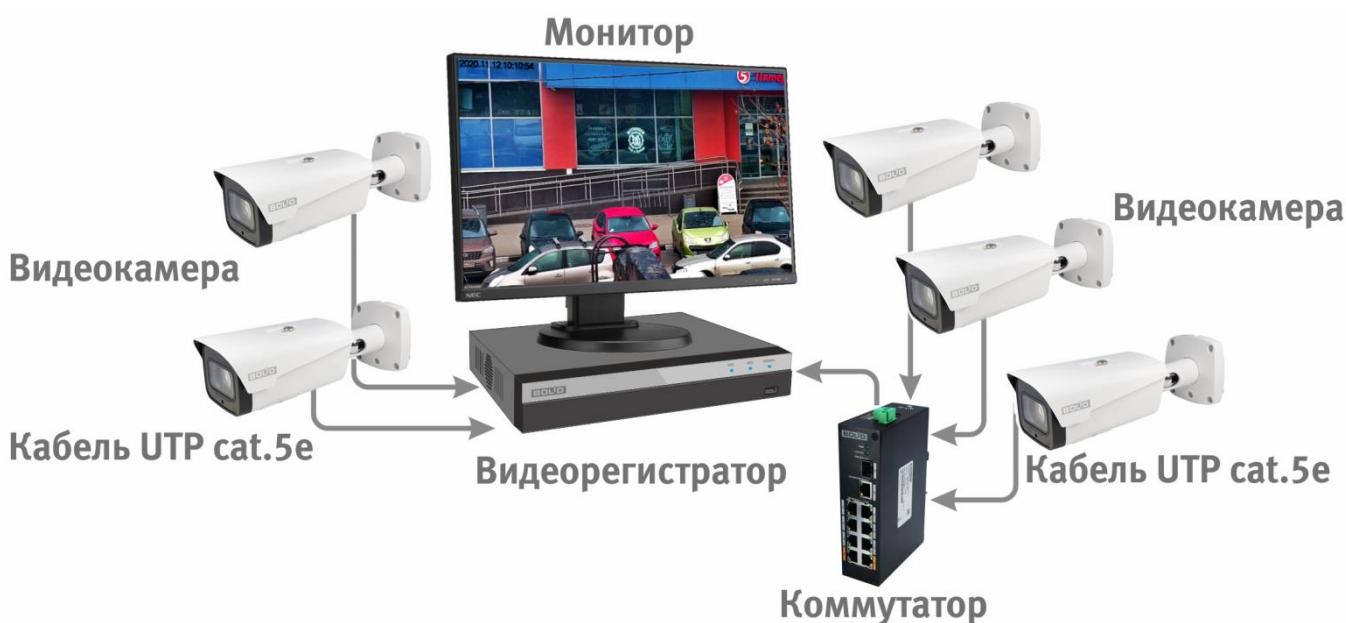
Рисунок 6.5 – Схема подключения видеокамеры к видеорегистратору
