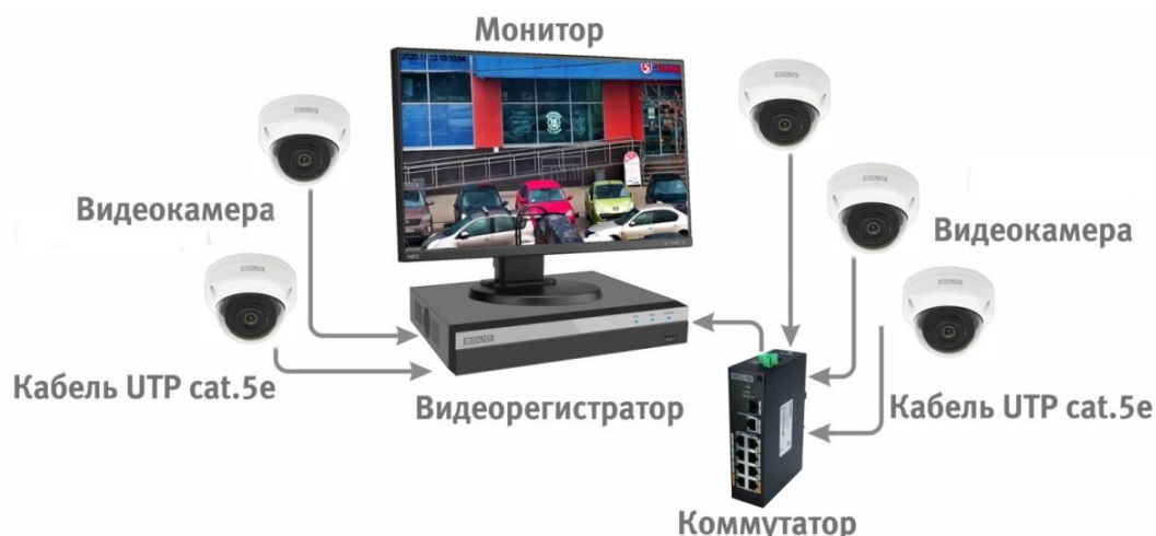
Рисунок 6.4 – Схема подключения видеокамеры к видеорегистратору
