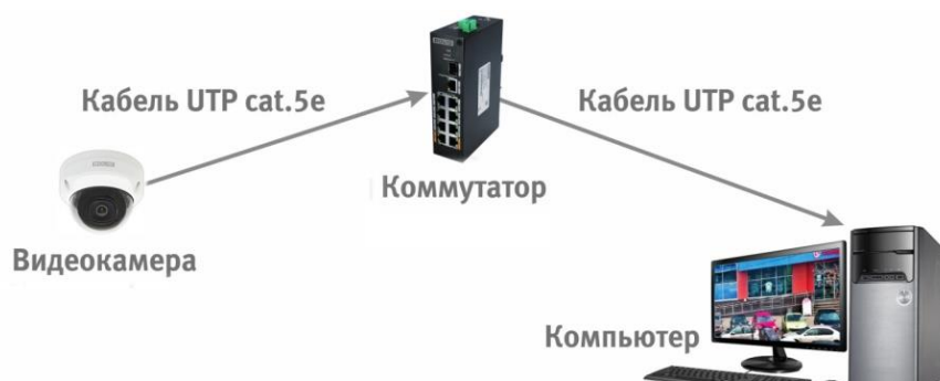
Рисунок 6.3 – Схема подключения видеокамеры к компьютеру через коммутатор
