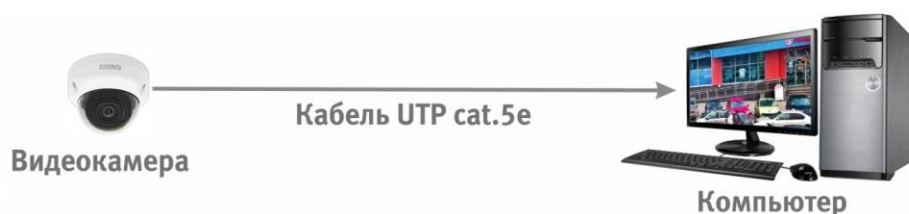
Рисунок 6.2 – Схема подключения видеокамеры к компьютеру
