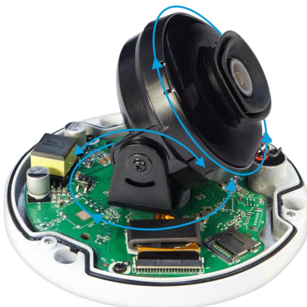
Рисунок 5.7 – Настройка направления объектива
