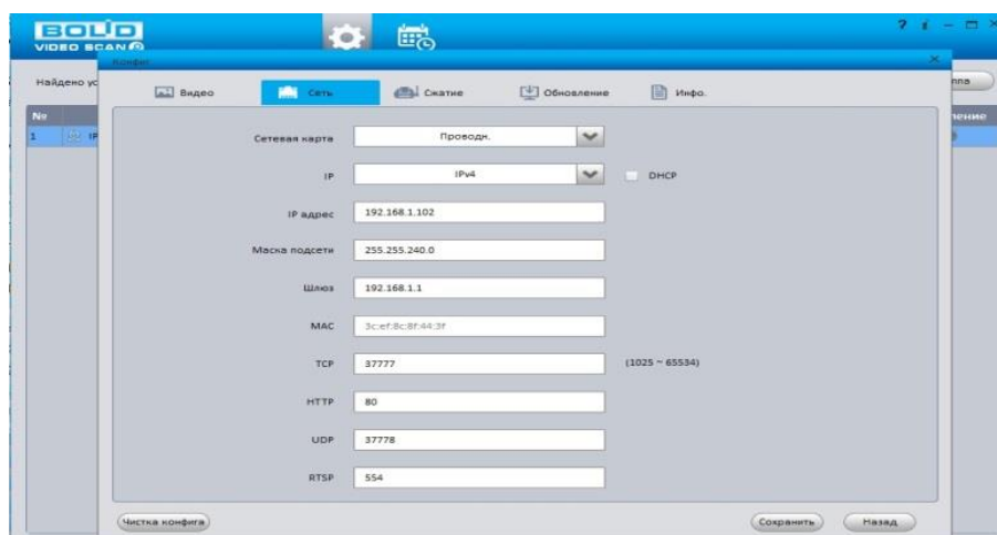
Рисунок 12.2 – Изменение IP-адреса видеочамеры с помощью утилиты «BOLID VideoScan»
