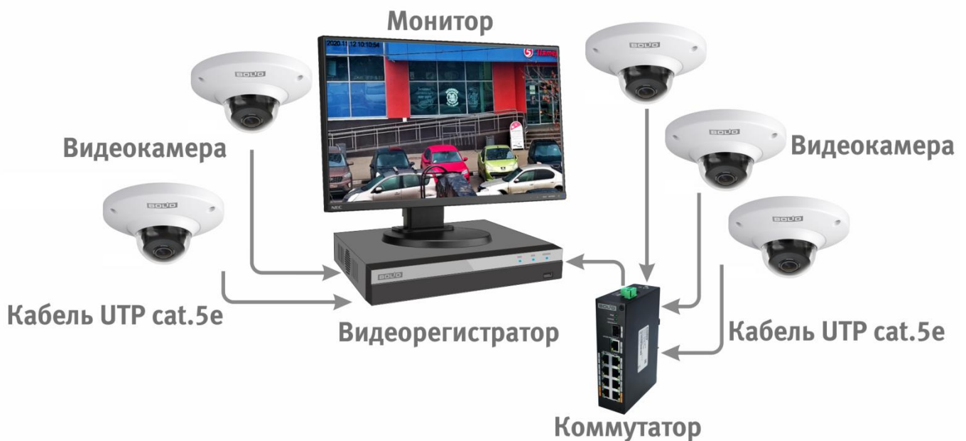
Рисунок 6.4 – Схема подключения видеокамеры к видеорегистратору
