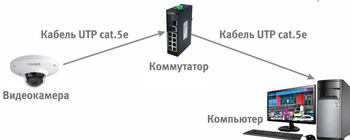
Рисунок 6.3 – Схема подключения видеокамеры к компьютеру через коммутатор
