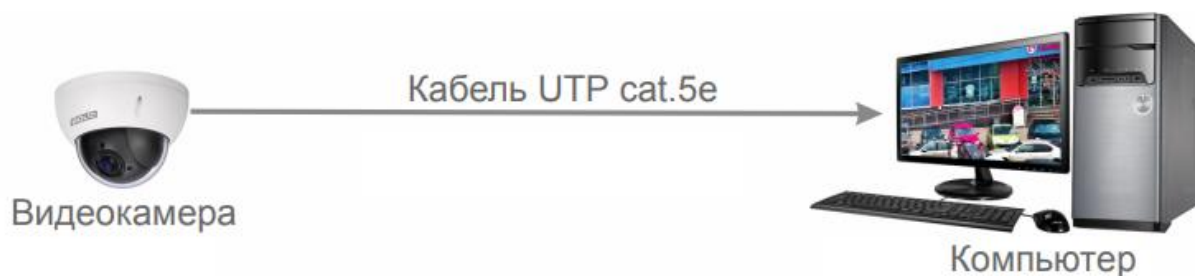
Рисунок 6.2 – Схема подключения видеокамеры к компьютеру
