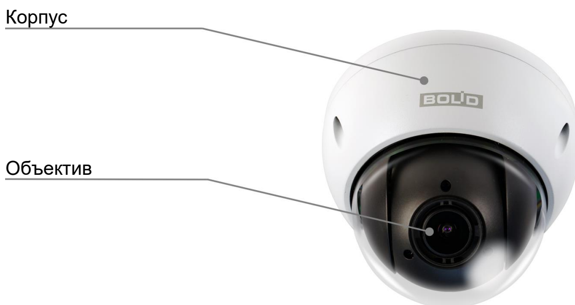
Рисунок 4.1 – Внешний вид и основные элементы видеокамеры
