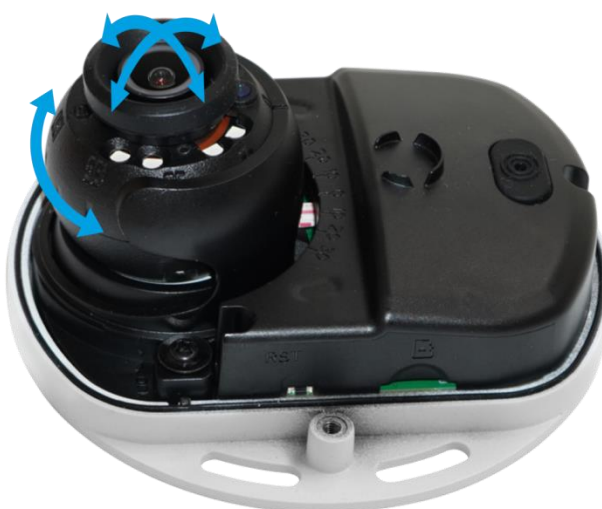
Рисунок 5.7 – Настройка направления объектива
