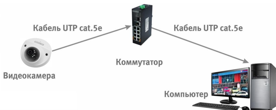
Рисунок 6.3 – Схема подключения видеокамеры к компьютеру через коммутатор
