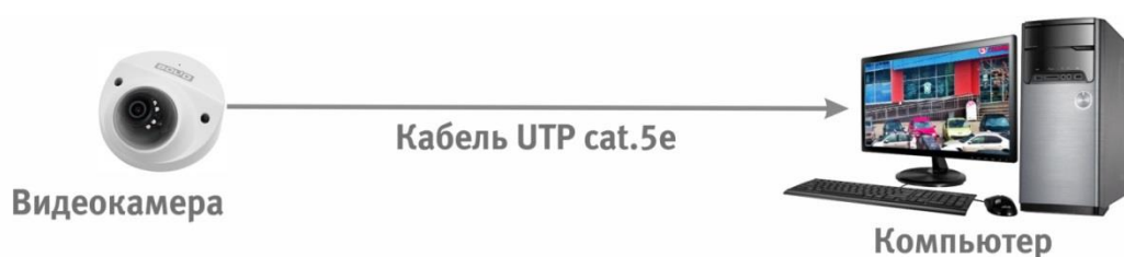
Рисунок 6.2 – Схема подключения видеокамеры к компьютеру
