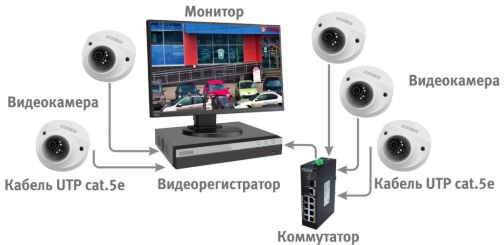
Рисунок 6.4 – Схема подключения видеокамеры к видеорегистратору
