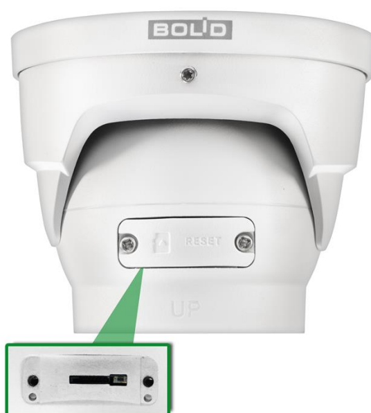
Рисунок 4.2 – Расположение кнопки аппаратного сброса и слота для карты памяти
