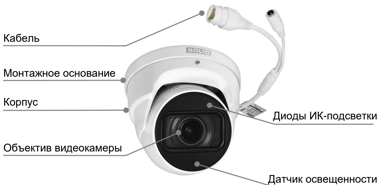
Рисунок 4.1 – Внешний вид и основные элементы видеокамеры
