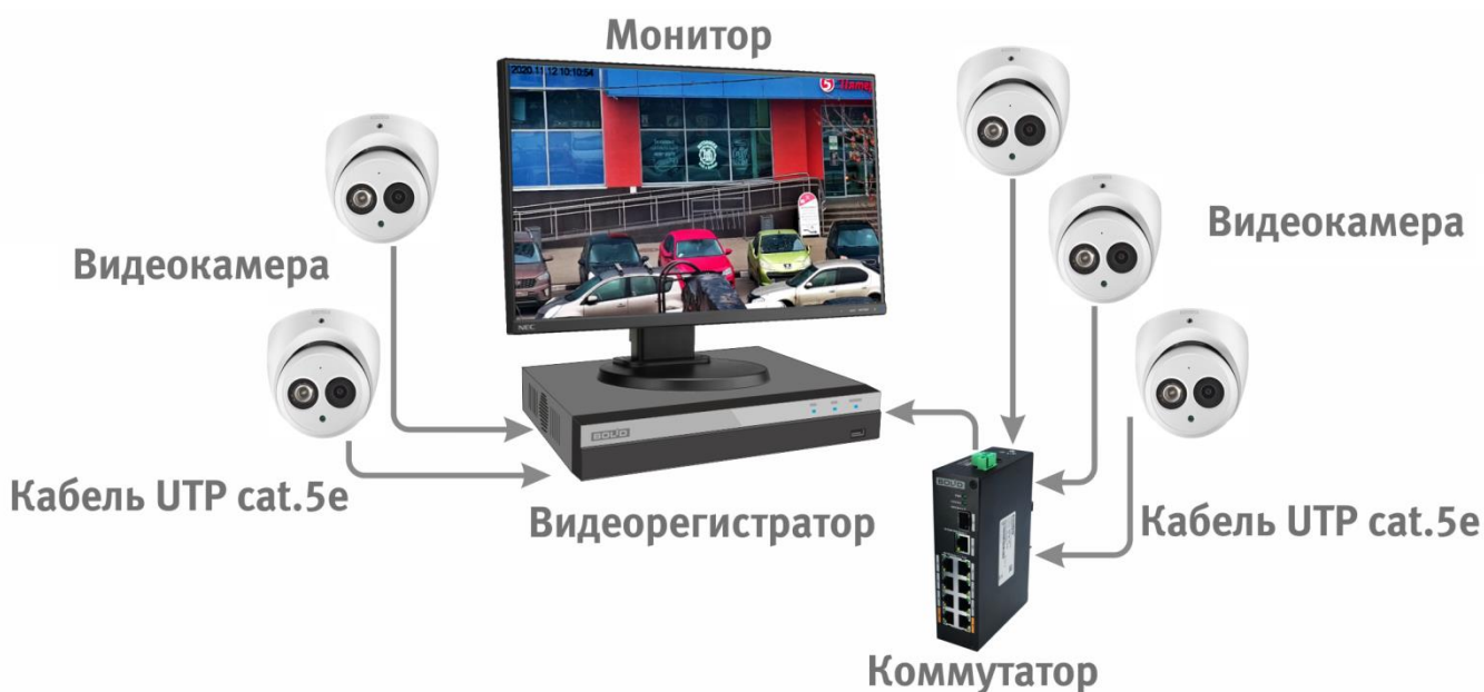
Рисунок 6.4 – Схема подключения видеокamеры к видеорегистратору
