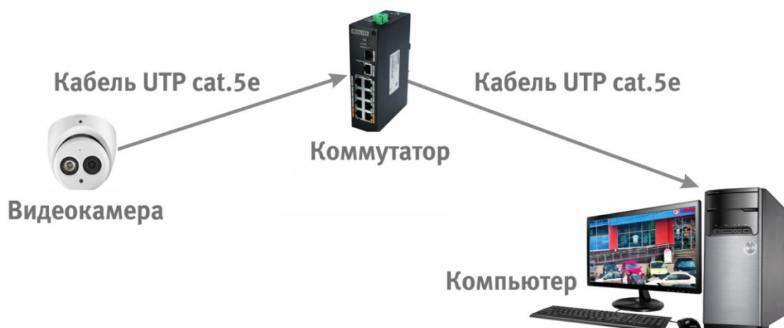
Рисунок 6.3 – Схема подключения видеокамеры к компьютеру через коммутатор
