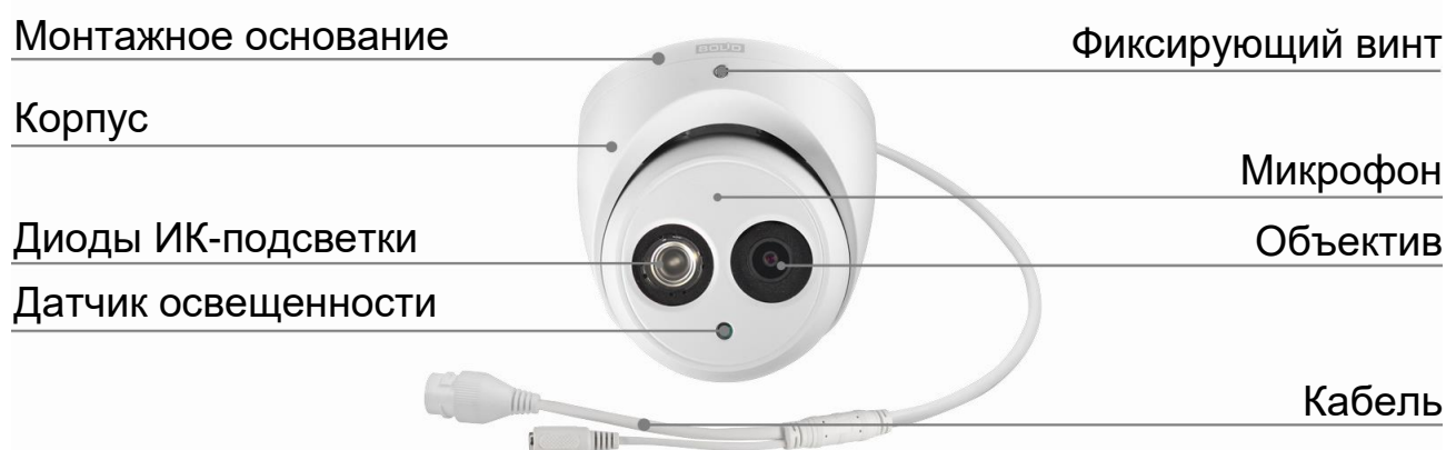
Рисунок 4.1 – Внешний вид и основные элементы видеокамеры
