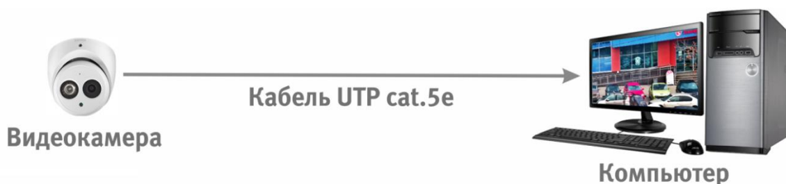
Рисунок 6.2 – Схема подключения видеокамеры к компьютеру
