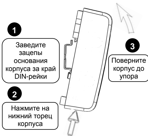
Рисунок 3. Крепление информатора на DIN-рейку
