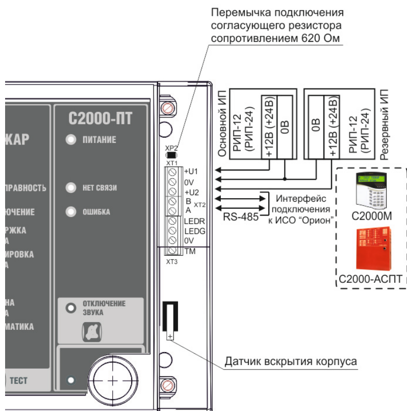
Рисунок 2. Схема внешних соединений блока «С2000-ПТ»
