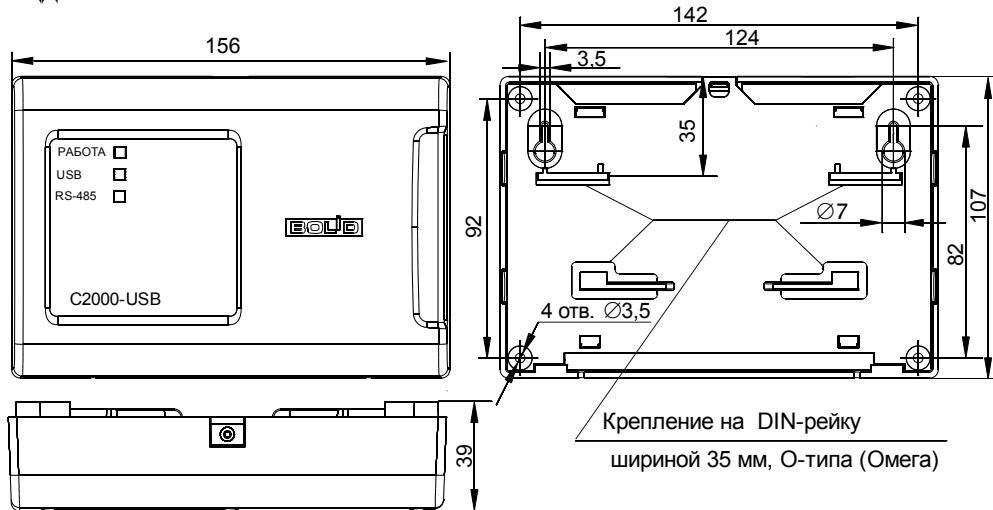
Рисунок 2. Габаритные и установочные размеры «С2000-USB»
