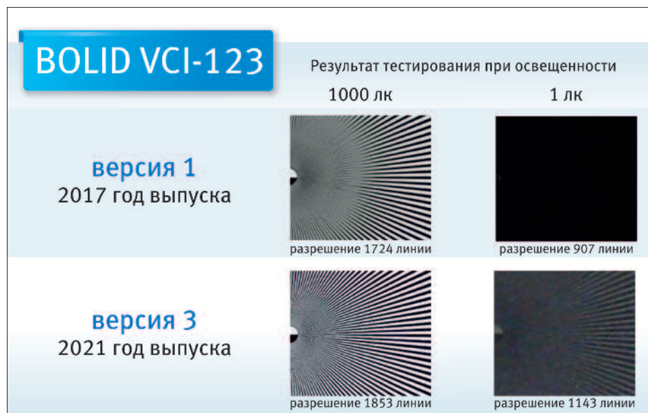
Рис. 2. Разрешающая способность при низкой и высокой освещенности без ИК-подсветки
