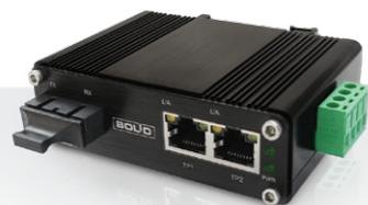
Преобразование сигналов интерфейса Ethernet стандартов 10/100/1000Base-T(X) в оптические сигналы стандартов 100/1000Base-FX, либо 100/1000Base-FX WDM и передача их на расстояние до 40 км.
