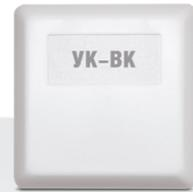
Используется совместно с контроллером доступа С2000-2, работающим в режиме «Шлагбаум», для управления светофором, а также коммутации исполнительных устройств в системах охранно-пожарной сигнализации и контроля доступа. Устройство содержит два реле с переключающими контактами и схему управления, позволяющую включать реле сигналом уровня логическая «1» (+ 5В КМОП).
