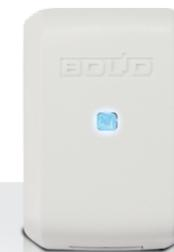
Подключение приборов к ПК с АРМ «Орион Про». Обеспечивает гальваническую изоляцию и взаимное преобразование сигналов интерфейса USB и сигналов двухпроводного магистрального интерфейса RS-485.
