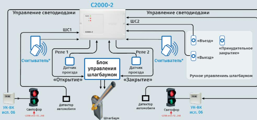
Считыватель\* — для выбора модели считывателей обратитесь в соответствующий раздел данного каталога
